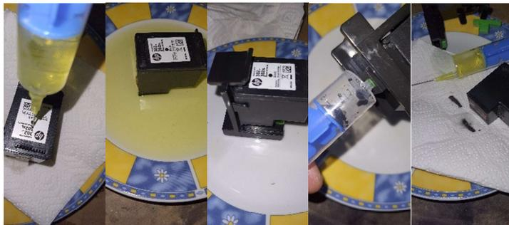
Sie befüllen Tintenpatrone mit 2-3 ml Druckkopfreiniger
