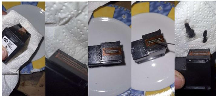
Sie tropfen auf die Düsen paar Tropfen Druckkopfreiniger -warten und tropfen weitere Male. Wenn Druckkopfreiniger schnell durch die Düsen eingesaugt werden haben Sie schon Erfolg. Saugen Sie mit einem Saug-Adapter die Tinte / Druckkopfreiniger aus den Düsen. Anschließend die Kontakte putzen mit einem Tempo und testen, ob die Drüsen richtige „Tintenstreifen“ auf dem Tempo ergeben.
